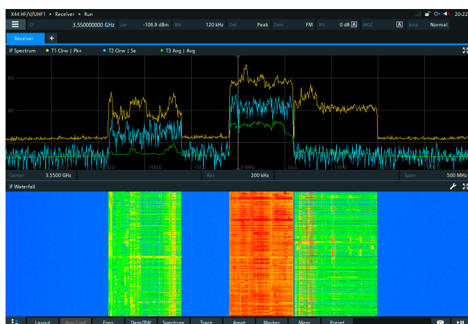
500 MHz实时带宽,支持至多三个可配置的频谱迹线
