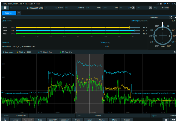
同时显示多达三个不同电平检波器测量的信号场强结果
