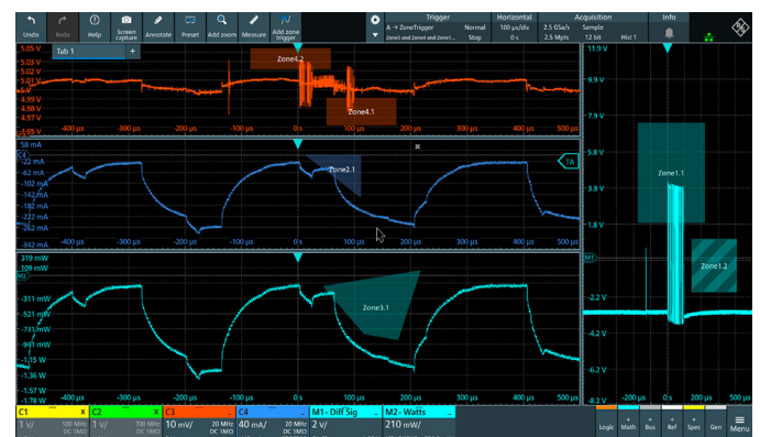
在射頻傳輸過程中利用區域觸發進行電源路徑量測來隔離功耗事件
