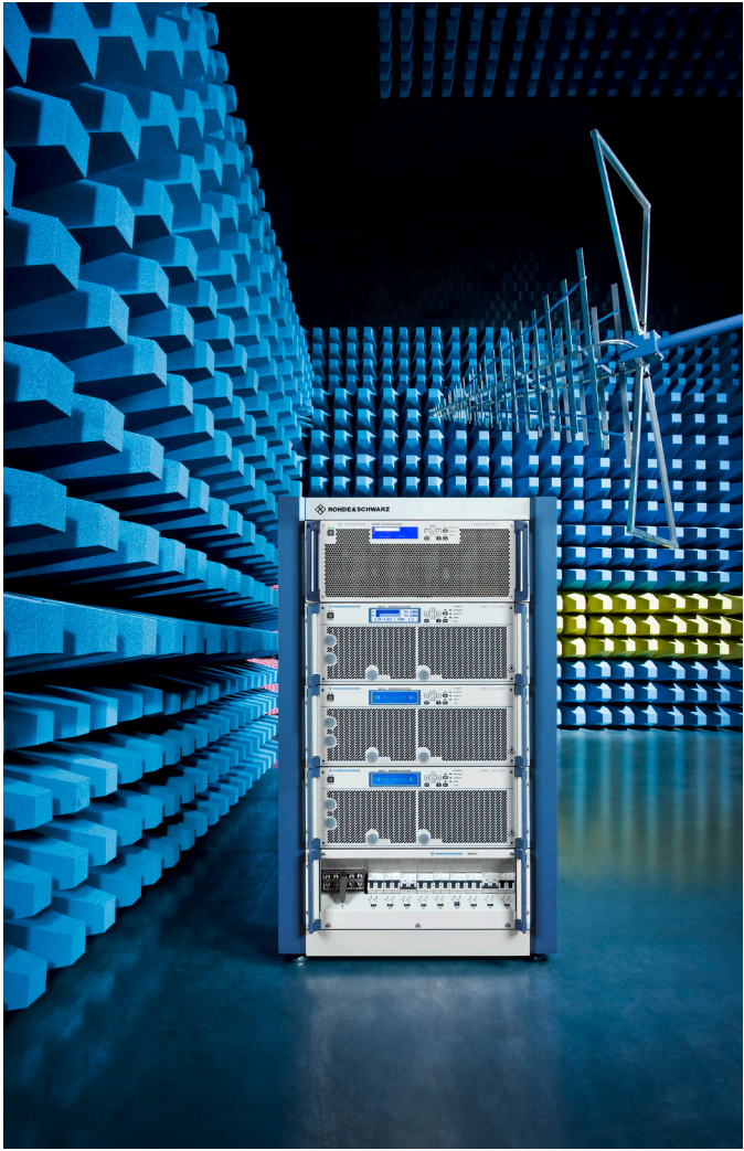
4 kHz ~ 6 GHz의 Radiated Electromagnetic Susceptibility 시험에 사용되는 1 x R&S®BBA300 및 3 x R&S®BBA150 증폭기 시스템.
