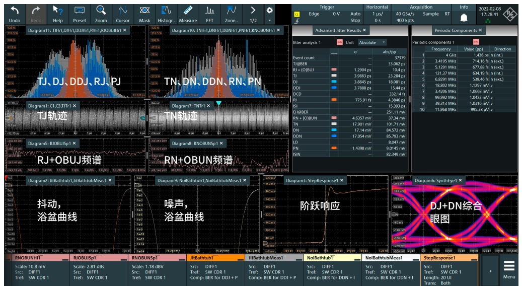
显示8 Gbps PCIe Gen3信号的阶跃响应、各抖动和噪声成分直方图、频谱、综合眼图和误码率浴盆曲线。
