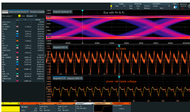
将电源纹波和高速信号的抖动成分(如周期性抖动)相关联
