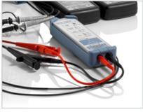
프로브 팁과 커넥터 유형에 대한 선택 또한 CMRR에 큰 영향을 미칩니다. 일반적으로 기존 고전압 디퍼런셜 프로브가 측정 요건을 제대로 충족하지 못하는 이유는 프로빙 지점에 연결되는 방식이 대부분 4 mm 플러그와 잭, 그리고 악어 클램프 또는 긴 니들 팁을 사용하기 때문입니다. 프로브 팁과 커넥터의 연결은 고전압 측정 시 안전을 보장하고 충분한 절연 요건(Creepage) 거리를 확보하기 위해 필요합니다. + 단자와 - 단자 사이의 신호 경로에 약간의 불일치라도 있다면 공통 모드 노이즈를 억제할 때 디퍼런셜 연산 증폭기의 효율이 감소합니다. 또한 긴 케이블과 충분하지 않은 차폐로 인해 DUT 주변의 공통 모드 노이즈에 취약해집니다.
