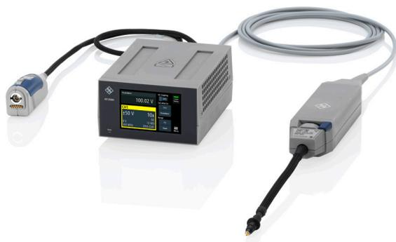
R&S®RT-ZISO 絶縁プロービング・システムは、BNCまたはSMAインタフェース（コネクタ）を備えたあらゆるオシロスコープに接続できます。プローブレシーバーは、プローブシステムの設定を制御したり表示したりするためのタッチスクリーン・ディスプレイを搭載しているため、プローブレンジやオフセット設定を容易に制御でき、接続されているプローブチップの表示も可能です。
