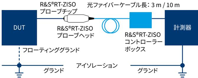
プローブヘッドからプローブシャーシボックスまでの信号伝送は光接続で行われ、プローブヘッドに必要な電力はファイバーを介して伝送されます。プローブヘッドは外部電源を必要としないため、バッテリーのような独立した電源を使用しない限りは、別のコモンモードループが生じる可能性は限定的です。
