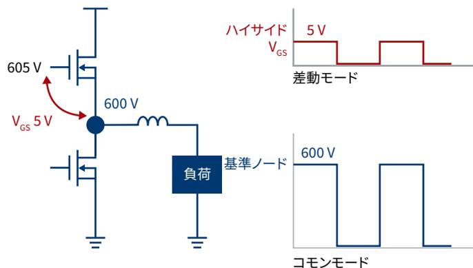
絶縁された電力変換の設計では、コモンランドがないためにDUTがフローティング状態になります。アース基準のある測定セットアップでは大きなグラウンドループが形成され、それにより、コモンモードノイズが結合して繊細なテスト結果に影響を及ぼす可能性があります。これは特に、高電力、3相インバーター、モータードライブの設計においてよく起こる問題です。
