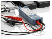
プローブチップとコネクタもCMRRに大きな影響を与えます。従来の高電圧差動プローブで要件を満たすのが困難である理由の1つは、プローブポイントへの接続が通常は4 mmのバナナプラグ/ジャックで、ワニ口クランプや長いニードルチップが使用される場合も多いからです。このような接続は、高電圧を使用する際の安全性の確保および十分な沿面距離を維持するために必要です。+ve端子と-ve端子間の信号経路にわずかでも不整合があると、コモンモードノイズを抑制する際に差動オペアンプの有効性が低下します。ケーブルが長い場合やシールドが不十分な場合にも、DUT周辺のコモンモードノイズの影響を受けやすくなります。
