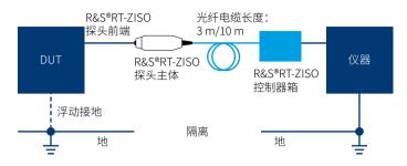
探头主体和探头接收机之间的信号传输采用光纤连接,探头主体通过光纤传输供电。探头主体不需要外接电源,除非使用电池等隔离电源,否则不会出现其他的共模环路。
