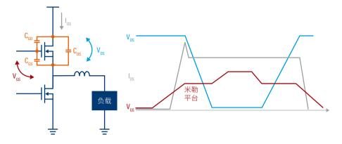
下方截图展示了使用R&S®RT-ZISO的High-side侧栅源电压测量。可以看到电压波形中出现了约持续1.85 ns的轻微下降,即米勒平台。若换做传统测量方式,High-side侧源极的共模开关信号会掩盖此位置,导致无法观察到。更快的开关节点有助于电路更快地响应负载变化,并有效减少晶体管开关时的开关损耗。传统高压差分探头在高频下的CMRR有限,测量采用新技术和架构的设计时会面临挑战。
