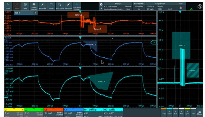
При измерениях шин питания функция зонального запуска позволяет выявлять события энергопотребления во время передачи ВЧ-сигналов
