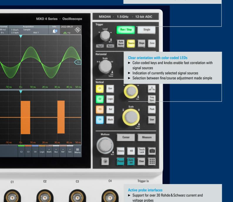
$\frown$  C1–C4, Trigger In: 1 M $\Omega$  :  $\leq$  300V RMS,  $\leq$  400 V pk; 50 $\Omega$  :  $\leq$  5V RMS
