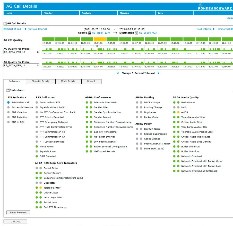
R&S®AVQA空对地监测器显示故障的准确时间和根本原因。
