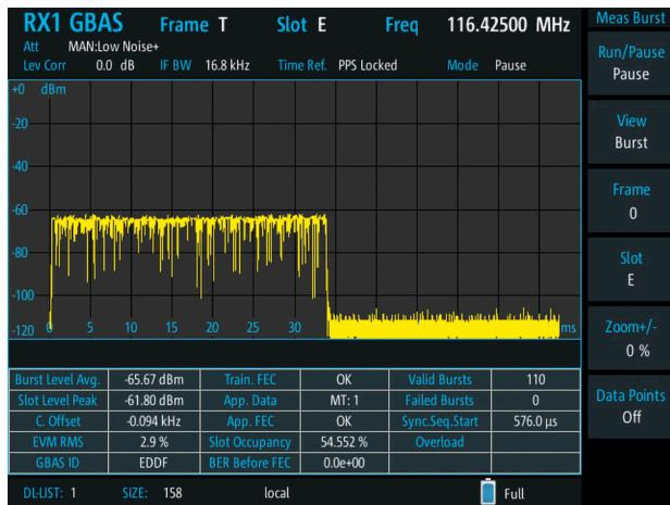
R&S®EVSG1000的GBAS突发视图，配备R&S®EVSG-K4 GBAS分析选件。
