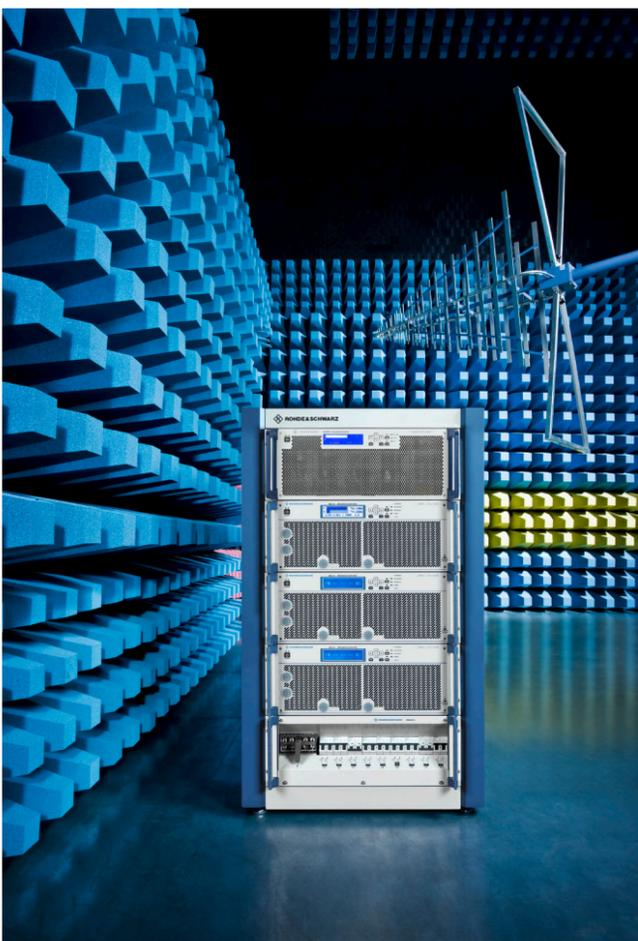
Sistema de amplificadores compuesto por 1 x R&S®BBA300 y 3 x R&S®BBA150 para utilizarse en ensayos de susceptibilidad electromagnética radiada de 4 kHz a 6 GHz.
