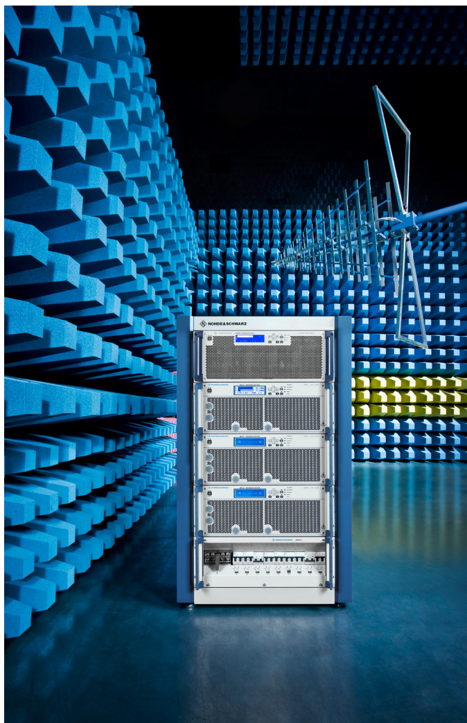
R&S®BBA300×1とR&S®BBA150×3で構成されたアンプシステムを設置した4 kHz～6 GHzの放射電磁感受性テスト。
