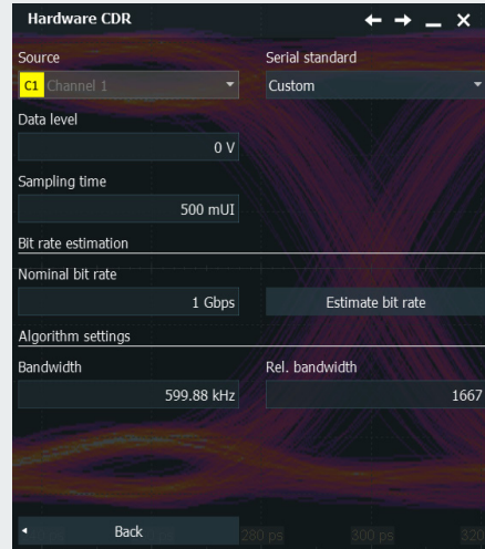
R&S®RTO6提供可配置的CDR功能,支持高达6 Gbps的数据速率来进行数据眼图分析。
