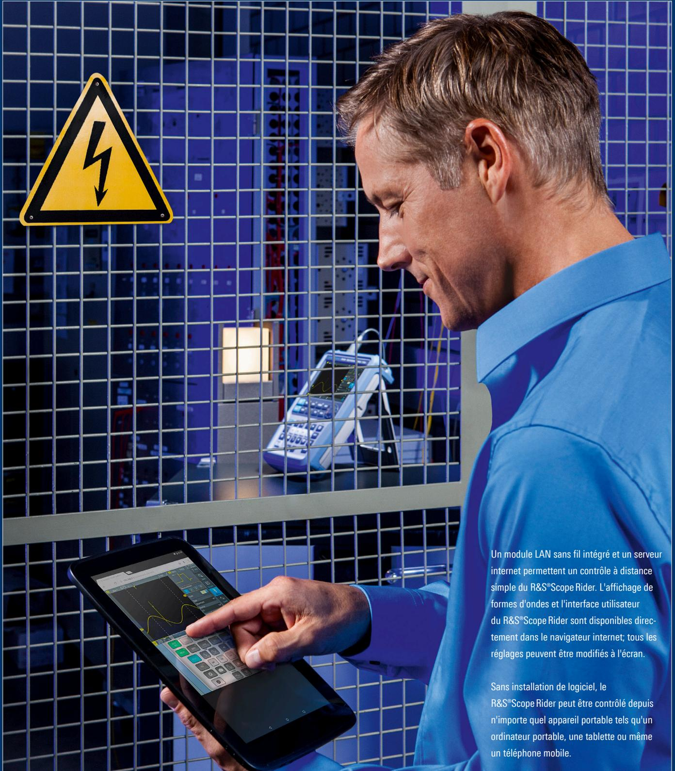
Un module LAN sans fil intégré et un serveur internet permettent un contrôle à distance simple du R&S®Scope Rider. L'affichage de formes d'ondes et l'interface utilisateur du R&S®Scope Rider sont disponibles directement dans le navigateur internet; tous les réglages peuvent être modifiés à l'écran.
