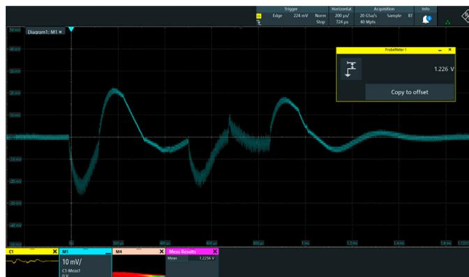
R&S®ProbeMeterとR&S®RTO6 オシロスコープの柔軟な演算機能を使用すれば、DDR3メモリの初期化中のDCレベルと電源負荷応答を正確に検証できます。
