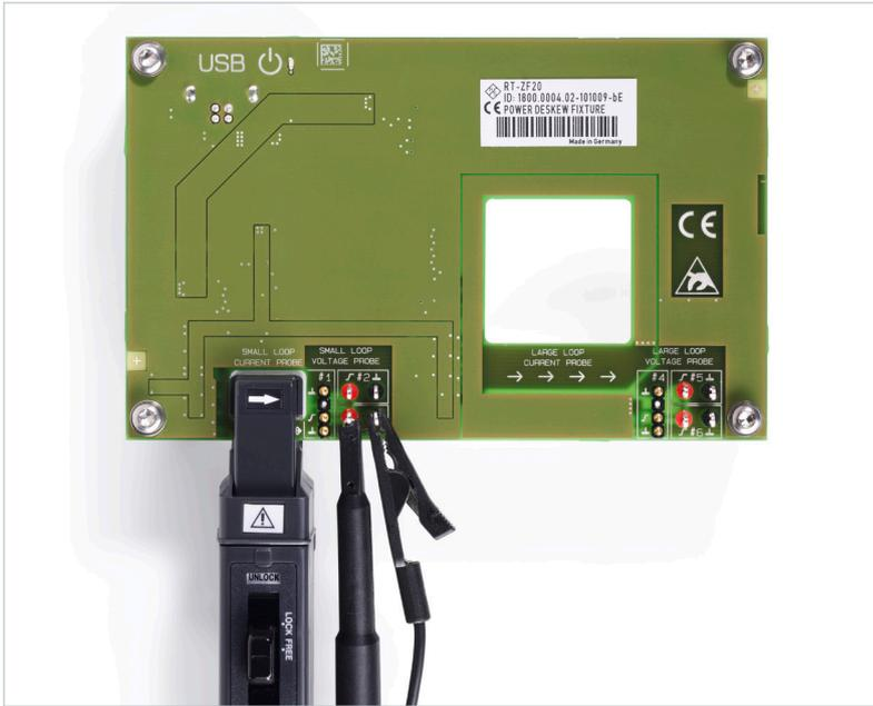
R&S®RT-ZF20 パワースキュー補正／校正テストフィクスチャ：パワーエレクトロニクス測定のための容易なスキュー補正。
