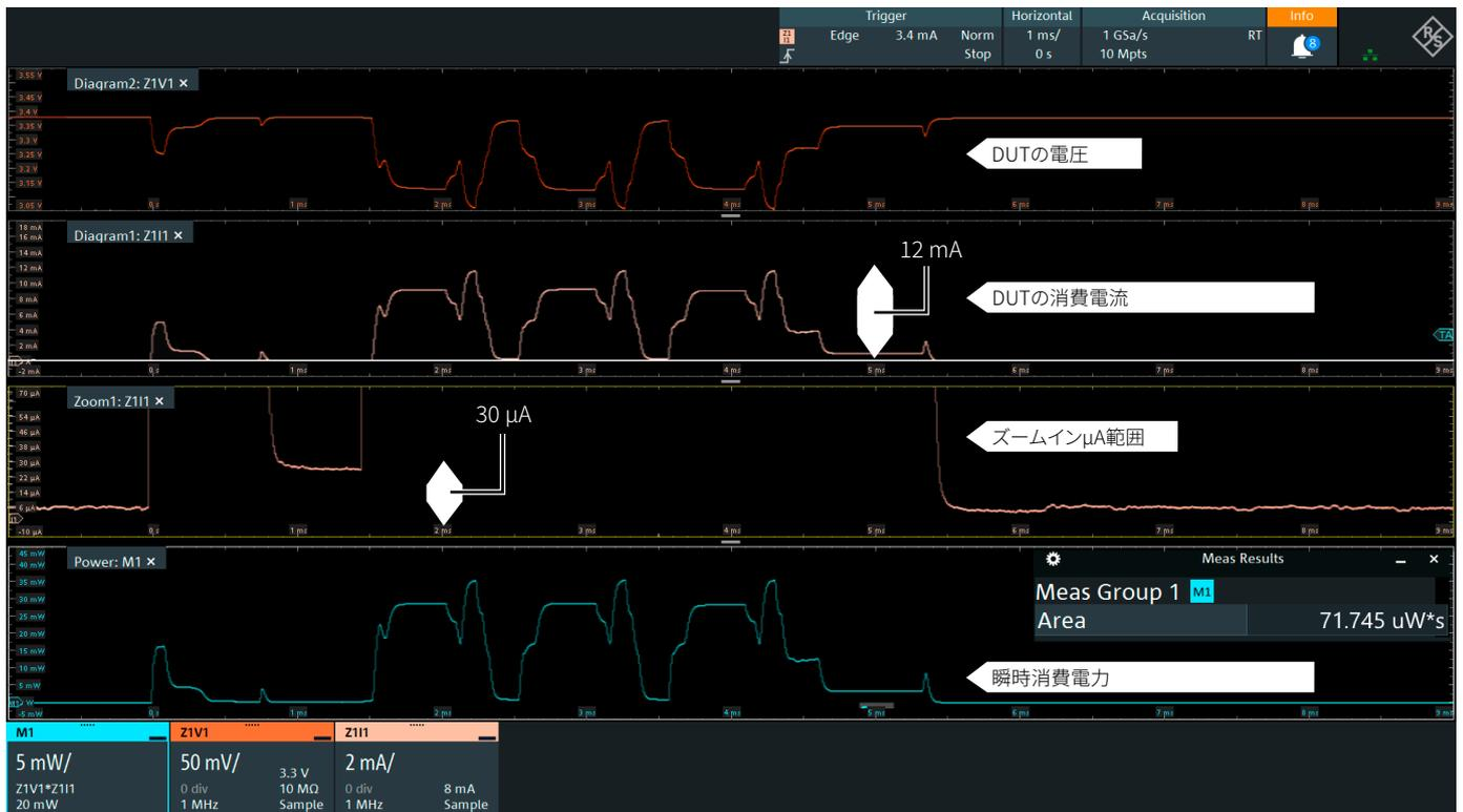
R&S®RT-ZVC プローブは、きわめて広いダイナミックレンジにより、アクティブ状態の電流とスリープ電流（この例では12 mAと30 μA）の両方を測定できます。自動測定により、全エネルギー消費を計算できます。
