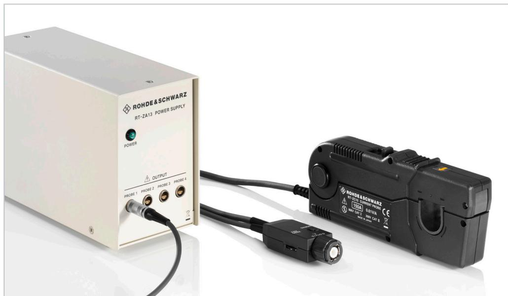
最大4本の電流プローブをサポートする外部電源
