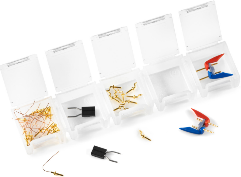
R&S®RT-ZD40: 点测式适配器以轻松调整探针偏移
