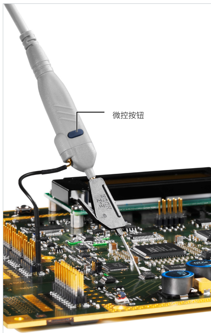
实用设计：带微控按钮，方便控制仪器 标配各种探头前端和接地电缆。
