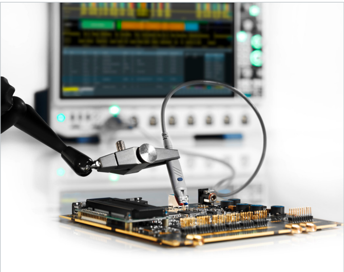
R&S®RT-ZAP 3D探头定位器搭配R&S®RT-ZD30一起使用
