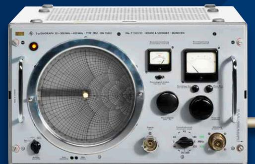
Bild 5: Der weltweit erste vektorielle Netzwerkanalysator (1950).
