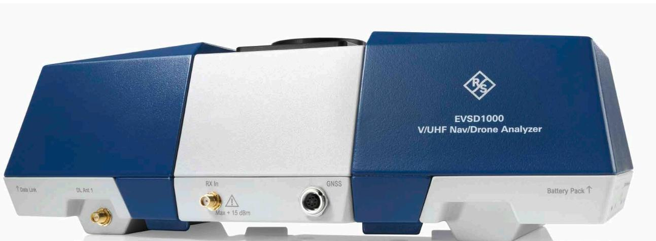
Bild 2: Der Signalpegel- und Modulationsanalysator R&S®EVSD1000 VHF/UHF Nav/Drone Analyzer ermöglicht eine vollständig ICAO-konforme, hochpräzise Vermessung von Instrumentenlandesystemen (ILS), bodengestützten Ergänzungssystemen (GBAS) sowie VHF-Omnirange-Bodenstationen (VOR). Darüber hinaus bietet er viele weitere Funktionen wie Spektrum-, Audio- und Zeitbereichsanalyse in einem Gerät.
