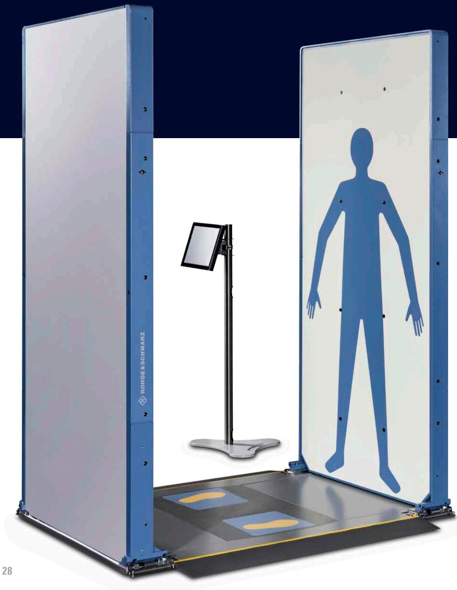
Die Einführung der R&S<sup>®</sup>QPS Sicherheitsscanner im Jahr 2014 durch Rohde & Schwarz hat der Millimeterwellentechnik in der Flugsicherheit zum Durchbruch verholfen. Dass damit auch die Welt ein Stück komfortabler geworden ist, spüren alle, die sich über deutlich verkürzte Sicherheitskontrollen freuen – nicht nur am Flughafen.
