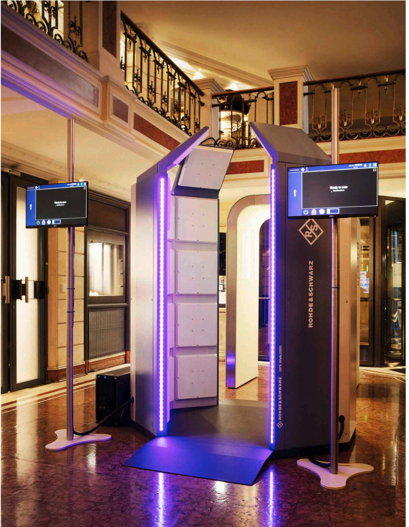
Bild 8: Der R&S®QPS Walk2000, hier ein Bild von der Münchner Sicherheitskonferenz im Jahr 2023, scannt eine Person beim Durchqueren, ohne das sonst übliche kurze Stillstehen. Auch die Oberbekleidung muss nicht abgelegt werden.
