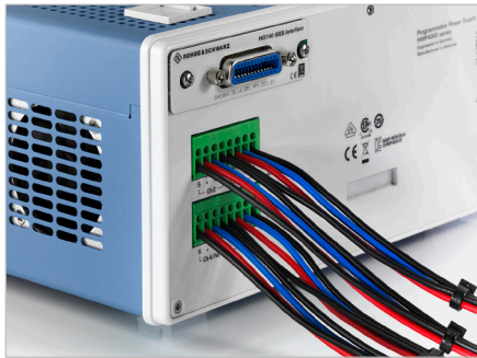
감지 라인(Sense Line)을 포함한 모든 연결 단자는 후면 패널에 위치합니다 (예: R&S®HMP4040).
