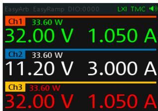
Различные рабочие состояния обозначаются цветом (на примере R&S®NGE103B).
