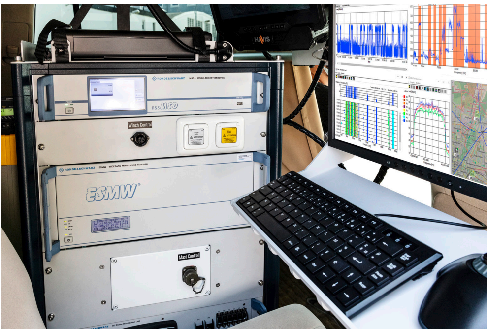
Fig. 2 : Le R&S®ESMW monté dans un tiroir 19 pouces dans une mesure sur véhicule.
