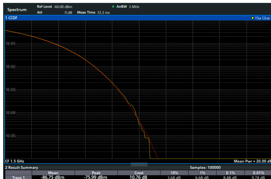
图25: 峰值因子曲线显示信号中出现最高峰值的概率较低
