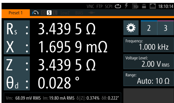
Jusqu'à quatre paramètres de mesure peuvent être affichés à l'écran simultanément
