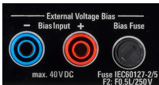
Ports pour des tensions de polarisation externe sur le panneau arrière
