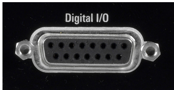
Ports E/S numériques sur le panneau arrière
