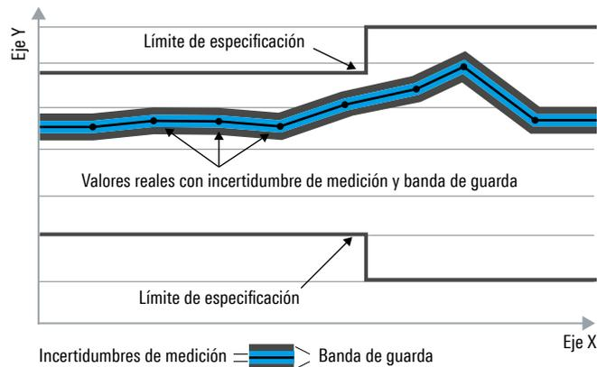
Los límites de las pruebas se reducen mediante bandas de guarda para tomar en cuenta las incertidumbres de mediciones, los desplazamientos y el envejecimiento, si corresponde.
