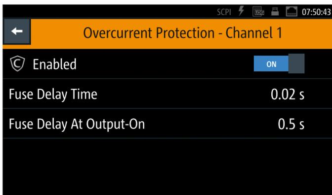
El usuario puede establecer límites de seguridad para limitar el rango de ajuste de la unidad de medición de fuente y evitar que un dispositivo bajo prueba resulte dañado por usar un ajuste incorrecto.
