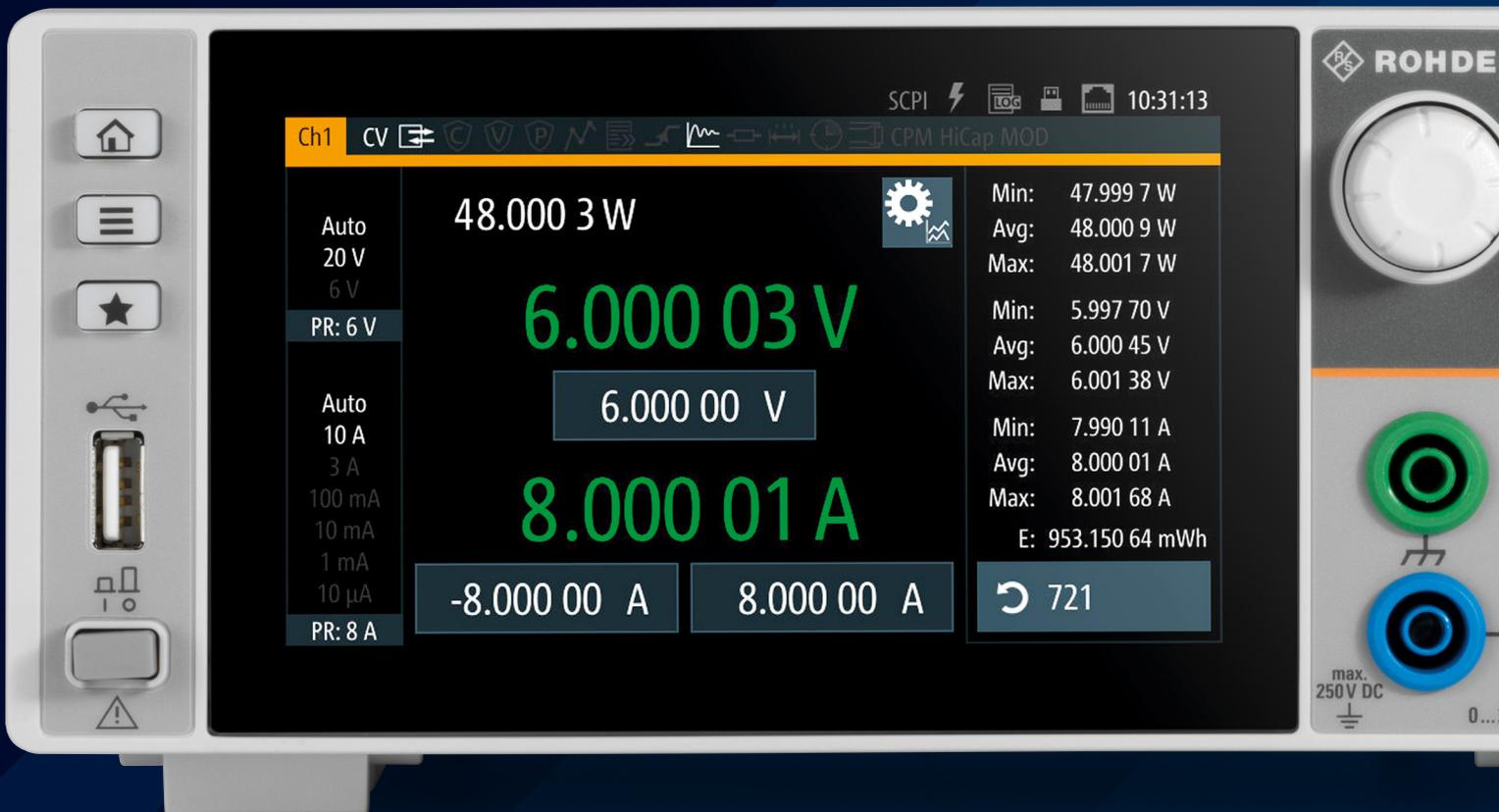
inalámbricas, principalmente diseñados para suministrar a los dispositivos bajo prueba corrientes extremadamente bajas en modo de reposo, tales como los dispositivos Bluetooth® de bajo consumo de energía.
