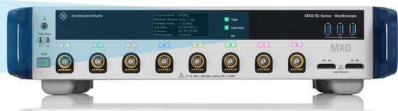
A microtela integrada fornece informações essenciais, inclusive o endereço IP: precisa encontrar rapidamente o endereço IP do instrumento? Precisa verificar se o osciloscópio já inicializou e/ou está em funcionamento? A primeira microtela de osciloscópios do mundo oferece acesso rápido e fácil a informações essenciais.
