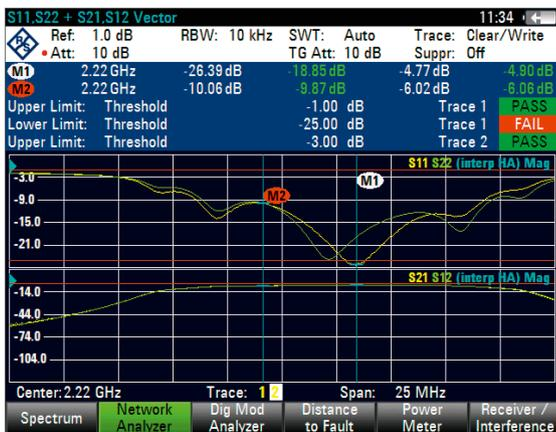
Modo do analisador de redes vetoriais: para caracterização e testes de antena e de perda de cabo, bem como medições de distância até a falha. Funcionalidade de duas portas para medições de transmissão
