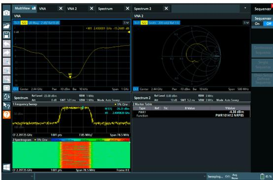
O MultiView oferece uma visão geral conveniente de todos os modos ativos do R&S®ZNL. A figura mostra uma combinação de analisador de espectro e analisador de redes. Nessa visão, todos os modos podem ser atualizados sequencialmente.
