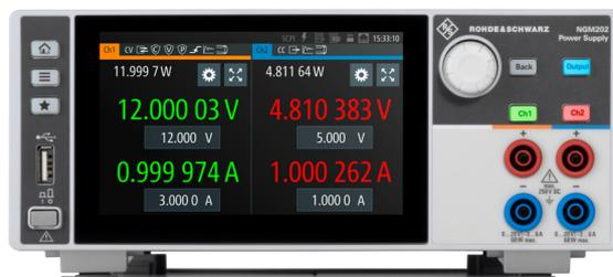
Fácil utilização: a tela sensível ao toque capacitiva de alta resolução é o elemento central da operação das fontes de alimentação R&S®NGM200. Os ícones mostram claramente o status de níveis de proteção definidos ou das funções especiais. Quando a fonte de alimentação está em modo de tensão constante, os números e as teclas acendem a luz verde. O vermelho é usado para o modo de corrente constante. O botão de saída acende a luz azul para indicar que os canais estão ligados (ativos).
