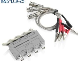
Adaptador para uma ampla gama de aplicações: os medidores LCR da Rohde & Schwarz podem realizar medições em uma grande variedade de componentes. Estão disponíveis adaptadores que correspondem à forma do componente.
