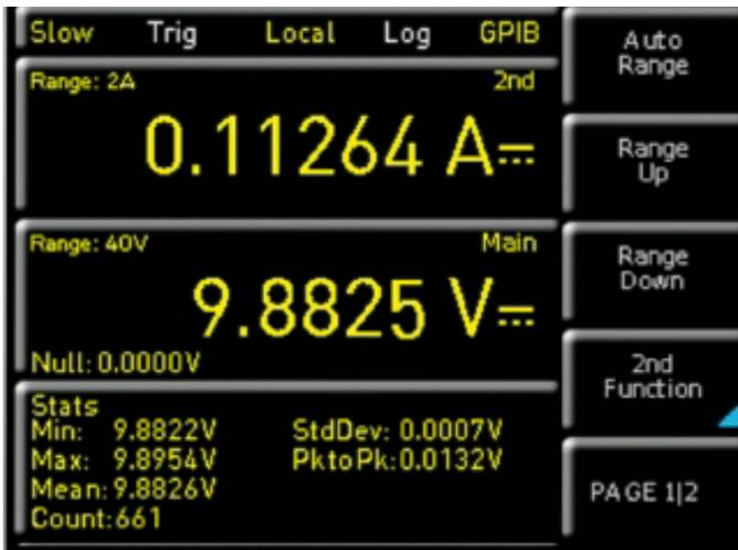
Exibição simultânea de medições: exibição simultânea de três medições, inclusive DCI e ACI, ao mesmo tempo
