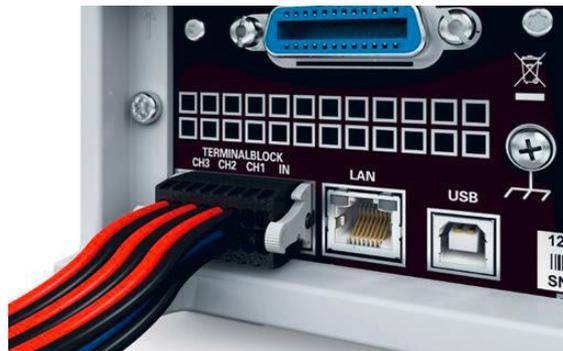
Tecnologia WAGO Cage Clamp: para facilitar as configurações normais de calibração, o conector do painel traseiro foi desenvolvido com a tecnologia WAGO cage clamp.
