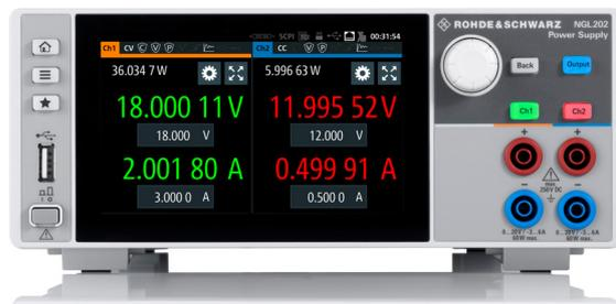
Fácil operação: a tela sensível ao toque capacitiva de alta resolução é o elemento central da operação das R&S®NGL200. Os ícones mostram claramente o status dos níveis de proteção definidos ou das funções especiais. Os canais ativos no modo de tensão constante são indicados pela luz verde; a luz vermelha é usada para indicar o modo de corrente constante. Quando os canais são ativados, a tela acende na cor azul (ativo).
