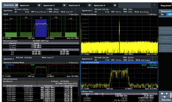
Interface de usuário flexível: configure as janelas de resultados da maneira que preferir. Visualize diferentes canais de medição ao mesmo tempo. A atualização sequencial de canais permite a medição paralela de, por exemplo, espectros, espectrogramas, análises I/Q e demodulação analógica.
