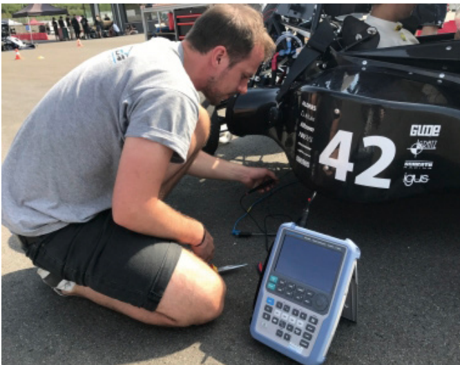
Niklas Waldstein misst an der Motorsteuerung des F17, um die Zündunterbrechung zu testen.
