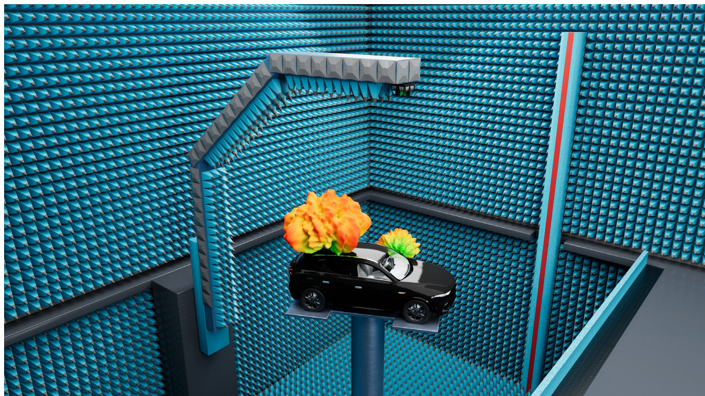
自動車に内蔵されたアンテナモジュールのテストと検証のための完全無響OTAアンテナテストチャンバー
