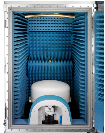
R&S®ATS1500CとR&S®ARC-TEMPオプションの組み合わせ
