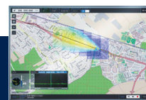
R&S® MobileLocator 高级干扰查找和发射 机定位软件
