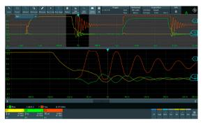
Цифровой запуск в серии МХО помогает анализировать сценарий и контролировать наличие достаточного времени простоя между коммутацией затворов на стороне высокого напряжения и на стороне низкого напряжения.
