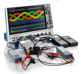
MXO с интерфейсом для подключения высоковольтных дифференциальных и токовых пробников в рамках анализа трансмиссии
