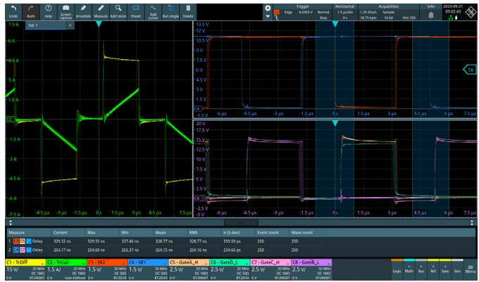
Рис. 2: Измеренные осциллограммы последовательности переключения полномостового преобразователя
