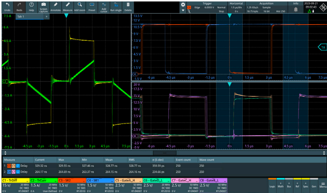
図2:フルブリッジコンバーターのスイッチングパターンの測定波形
