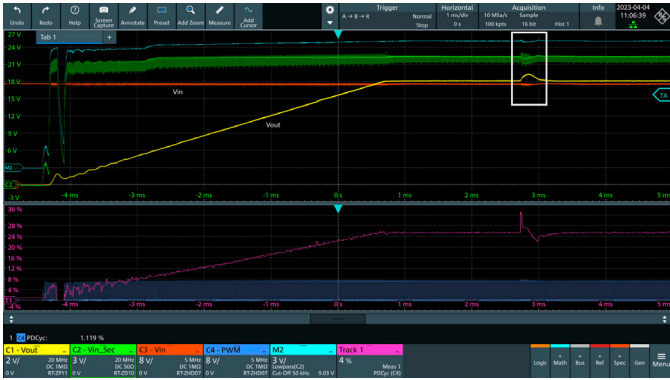
図5: コンバーターの起動と不規則な制御の効果
