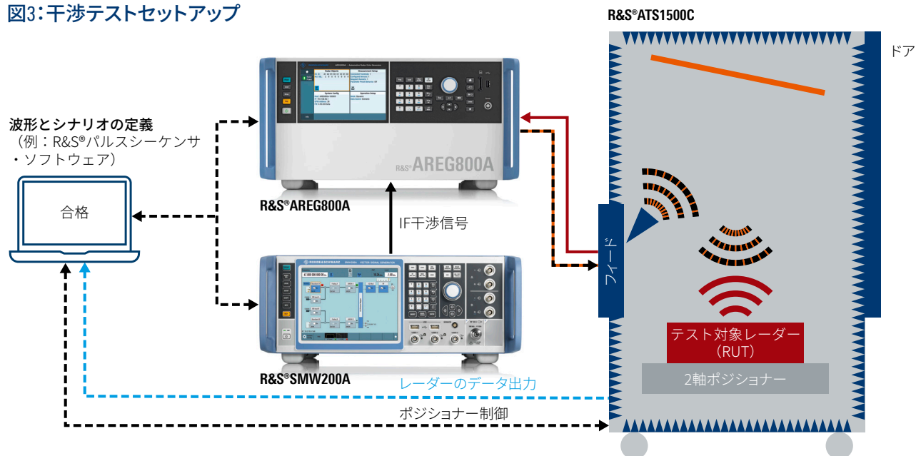
図3: 干渉テストセットアップ
