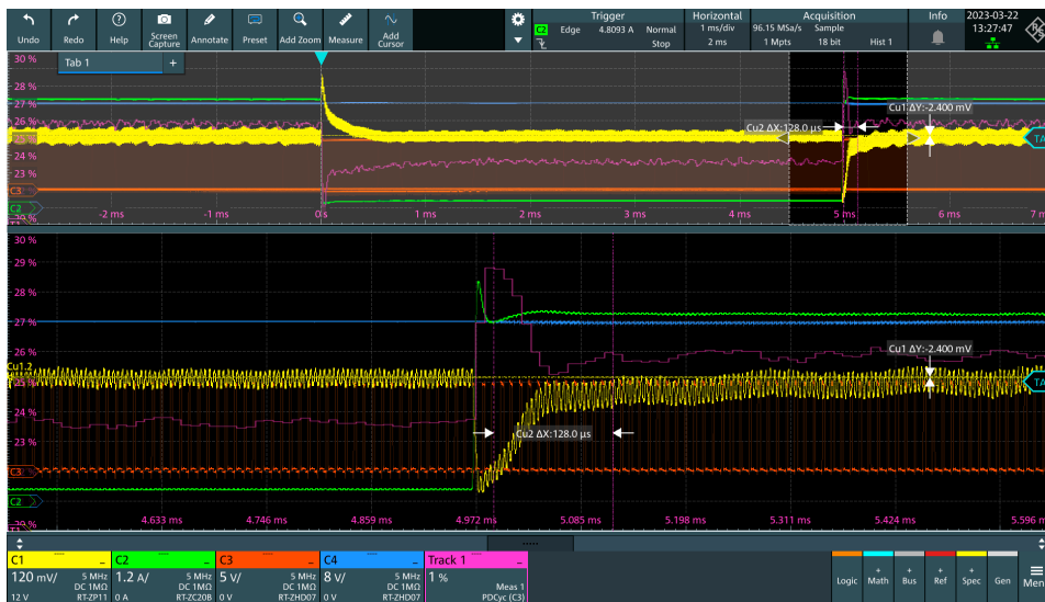
Рис. 3: Измерение переходной характеристики нагрузки в понижающем преобразователе
