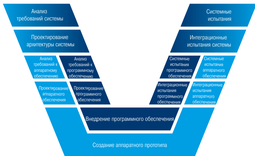
Рис. 2: Процесс разработки датчиков ADAS
