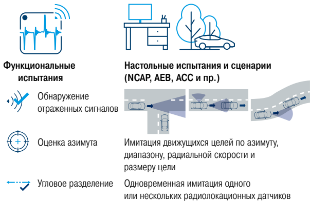
Рис. 4: Имитация радиолокационных целей и сценарии использования R&S®QAT100
