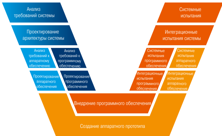
Рис. 6: Процесс разработки датчиков ADAS, сценарии использования R&S®QAT100 выделены оранжевым цветом
