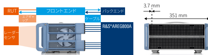
図9: センサの配置とR&S®QAT100の寸法
