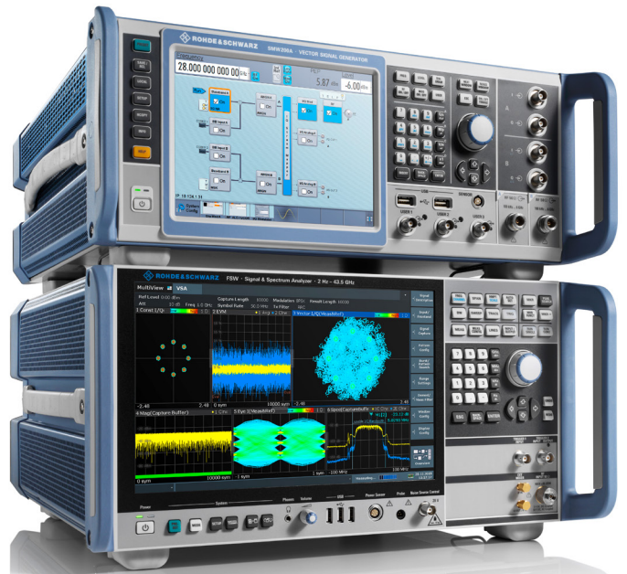
R&S®SMW200A和R&S®FSW组成的参考测试台，可在宽频率和带宽范围内满足严格的EVM性能要求。
