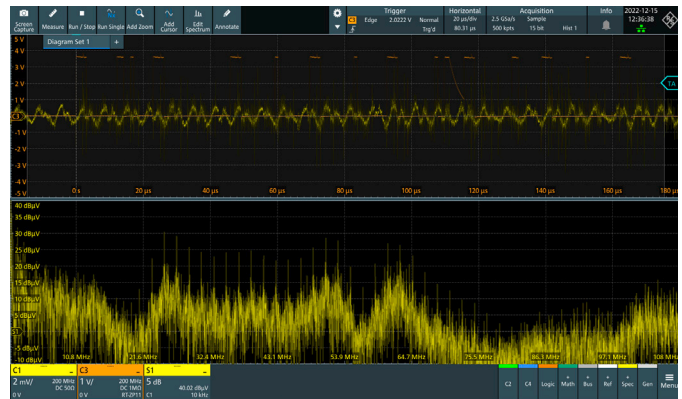
図3: SPIデータの伝送中のEMIスペクトラム。
