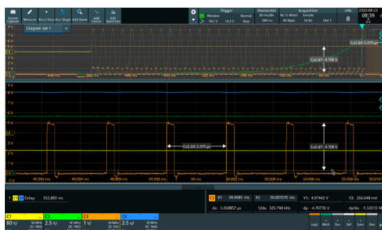
Рис. 3: Импульсы ШИМ в установленном режиме преобразователя
