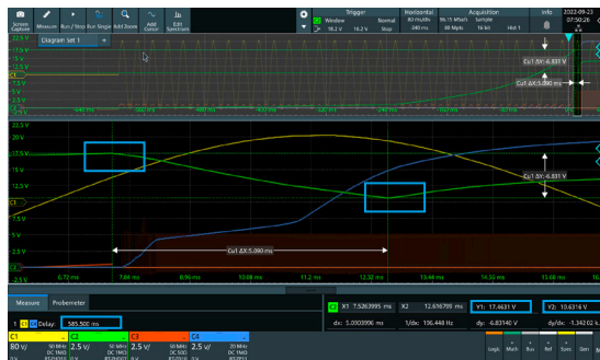
Рис. 2: Измерение последовательности запуска преобразователя
