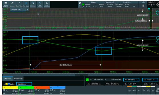
PWMパルス(チャンネル3)は、コントローラーの動作を詳細に示します。同じ測定データの別のズームウィンドウには、コンバーターの定常状態領域のPWMパルスが強調表示されます(図3を参照)。領域上にカーソルを移動すると、定常状態の周波数が表示されます。シーケンス内の他の重要ポイントに合わせて、ズームを調整することができます。
