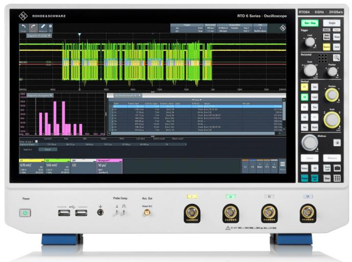
R&S®RT06 オシロスコープは、連続したSpaceWireデータストリームをトリガ／デコードします。
