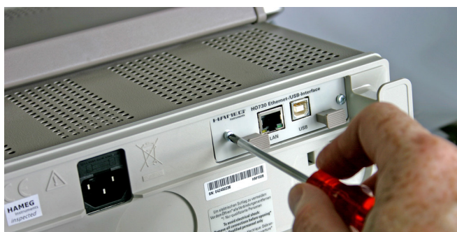
Abb. 2.4: Festschrauben der Schnittstellenkarte
