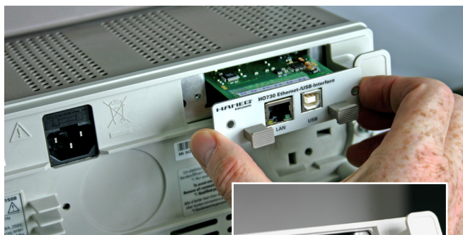
Abb. 2.3: Einsetzen der neuen Schnittstellenkarte
