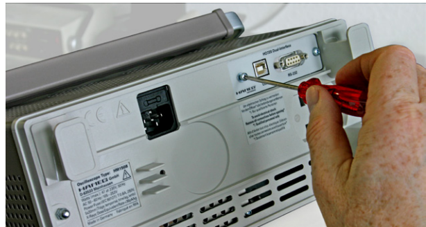
Abb. 2.1: Lösen der Befestigungsschrauben
