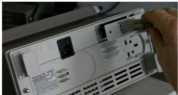
Abb. 2.2: Ausbau der Schnittstellenkarte
