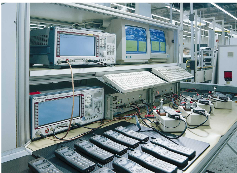
BILD 2 Digital Radiocommunication Tester der CMD-Reihe sind prädestiniert für den Einsatz in der Mobiltelefon-Herstellung beliebiger Standards. Foto 42 944/1
