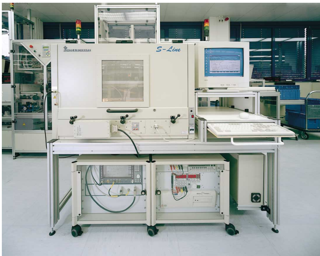
BILD 2 Zur Funktionsprüfung des Empfängers (in der EMV-Meßzelle S-Line 700/P) dient neben dem Universal-Testsystem TSU ein Radiocommunication Service Monitor CMS54 (unten links). Foto 43 027/2
