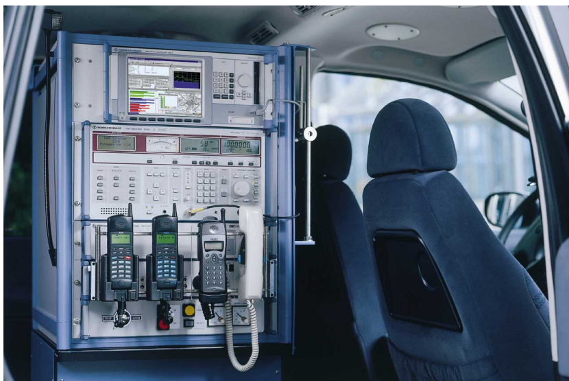
BILD 1 Versorgungsmesssystem TS9955 mit Meßempfänger ESVB als Herzstück. Foto 43 125/2
