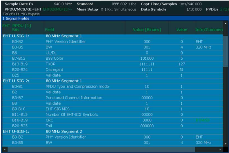
Bild 6: Im Modus Auto Detection stellt sich der Analysator automatisch auf ein angelegtes 802.11be-Signal ein und listet dessen Parameter.
