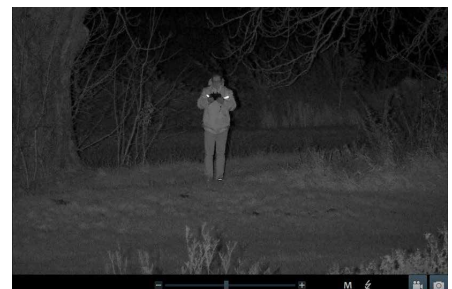
Bild 2: Ein Vorzug der Funkerfassungsmethode ist die Ortbarkeit der Fernsteuerung und damit auch des Drohnenpiloten. Die R&S®ARDRONIS-Kameras machen ihn mit ihrer Infrarot-Optik auch bei Nacht sichtbar.
