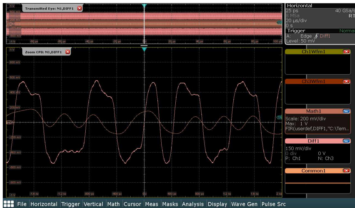
Bild 2: Erfassung der Messkurve „Short Channel“ eines USB-3.2-Gen1-Device an Kanal 1 und 3 und Echtzeitberechnung als differenzielles Signal (Diff 1). Berechnung des Signals „Long Channel“ durch Embedding der S-Parameter vom USB-IF (Math 1).
