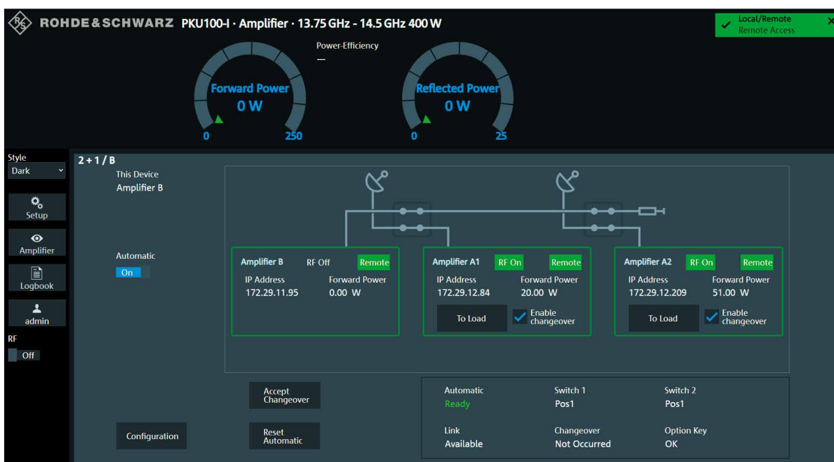
Bild 4: Eine Gruppe von R&S®PKU100-Uplink-Verstärkern, hier in 2+1-Redundanz konfiguriert, verwaltet sich autonom. Bei Ausfall eines Verstärkers übernimmt in Sekundenbruchteilen das Reservegerät.
