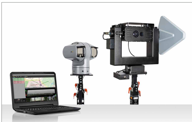
Bild 1: Die Software-Erweiterung R&S®ARDN-PTC ermöglicht die Ansteuerung motorisch einstellbarer Schwenk-Neige-Köpfe und Kameras. Die beiden angebotenen Kameramodelle bieten hohe Zoomfaktoren und eingebaute Infrarot-Spotlights für die Anleuchtung der Zielobjekte bei Nacht.
