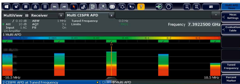
Bild 3: Nachmessung an der kritischen Frequenz mit der APD-Mehrkanal-Messung. Aus dem 2D-Diagramm lässt sich das Messergebnis qualitativ und quantitativ auf einen Blick ablesen.
