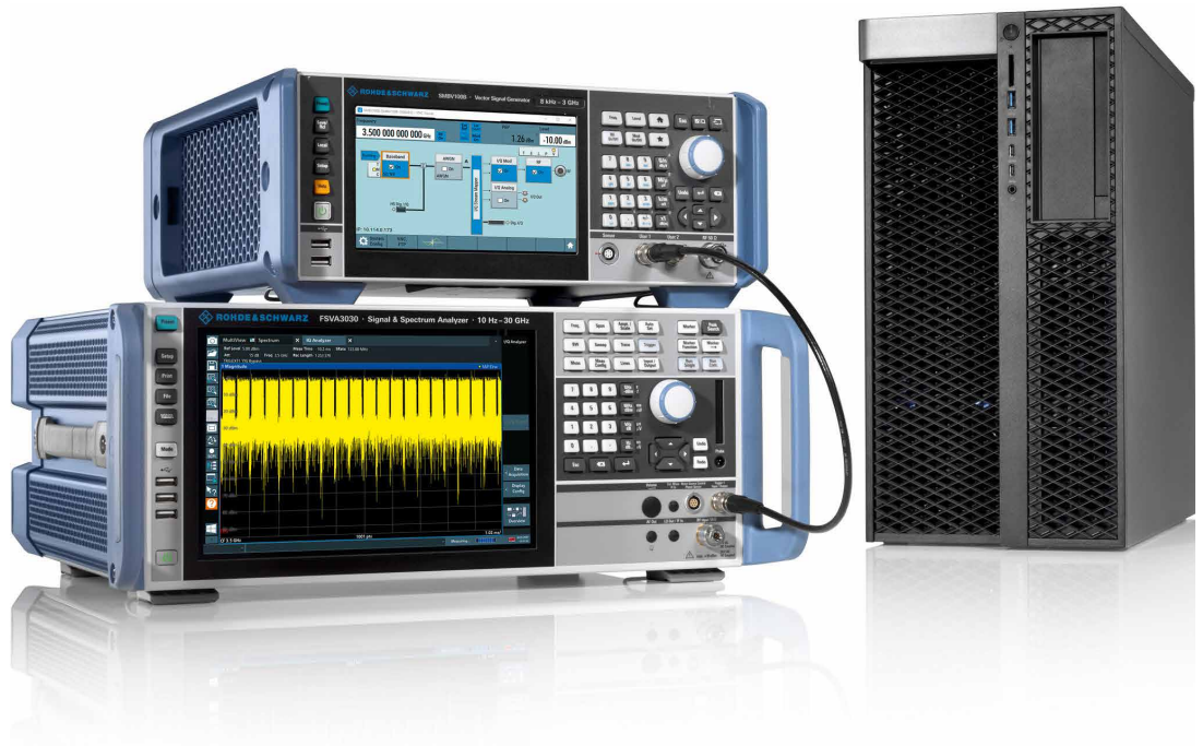
Bild 3: Bilden die Basis für eine höchst performante Charakterisierung von Basisstationsverstärkern: Vektorsignalgenerator R&S®SMBV100B als Stimulus-Quelle, Signal- und Spektrumanalysator R&S®FSVA3000 als I/Q-Datenlieferant sowie ein Standard-PC für die Kommunikation mit dem Server, der die Messergebnisse berechnet.
