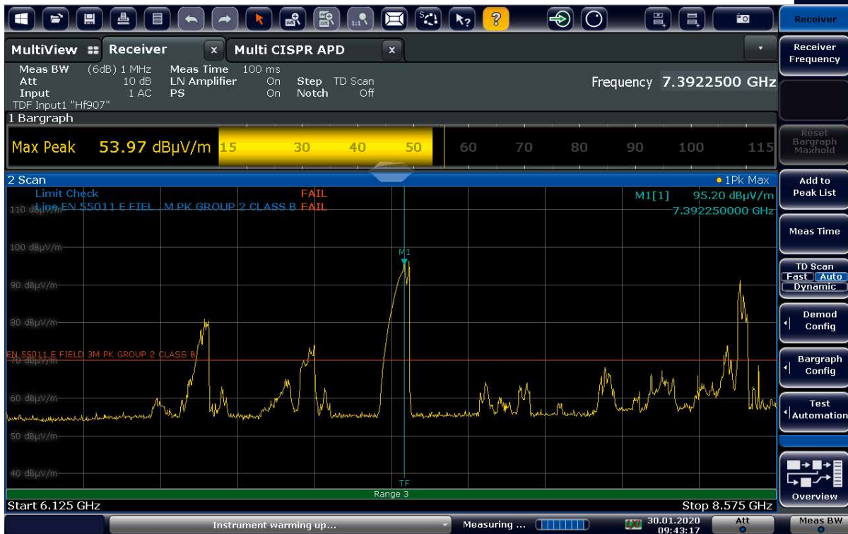
Bild 2: Vormessung an einem Mikrowellenherd mit dem Spitzenwertdetektor im Subband 3 (6,125 GHz bis 8,575 GHz). Die FAIL-Anzeige signalisiert, dass das Messergebnis den Grenzwert überschreitet. Um die kritische Frequenz herum – hier bei 7,39 GHz – muss deshalb mit der APD-Messfunktion nachgemessen werden.
