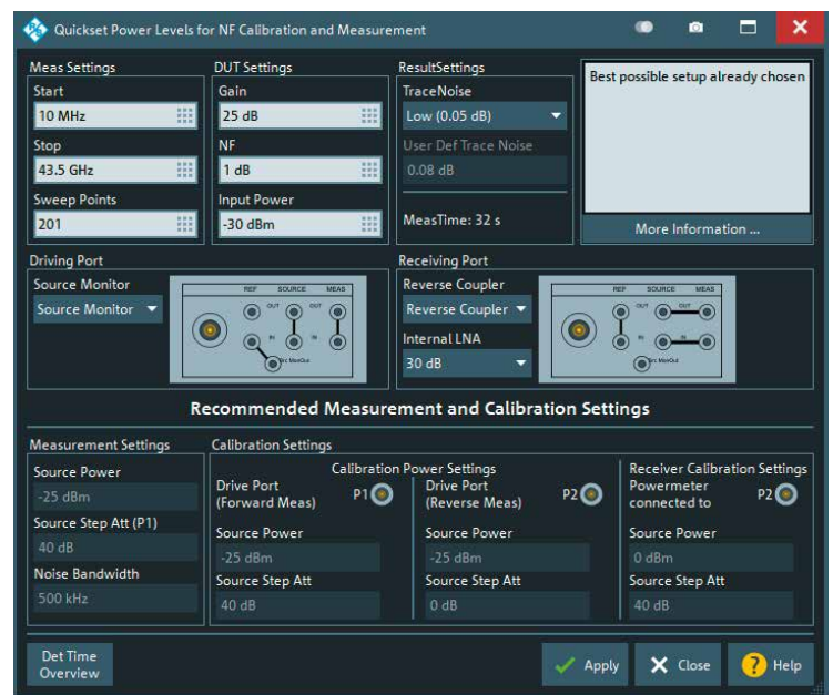
Bild 1: Einstellmenü der Rauschmessung. Sind wie in diesem Fall Optionen wie Vorverstärker und Source Monitor installiert, werden sie eingebunden.
