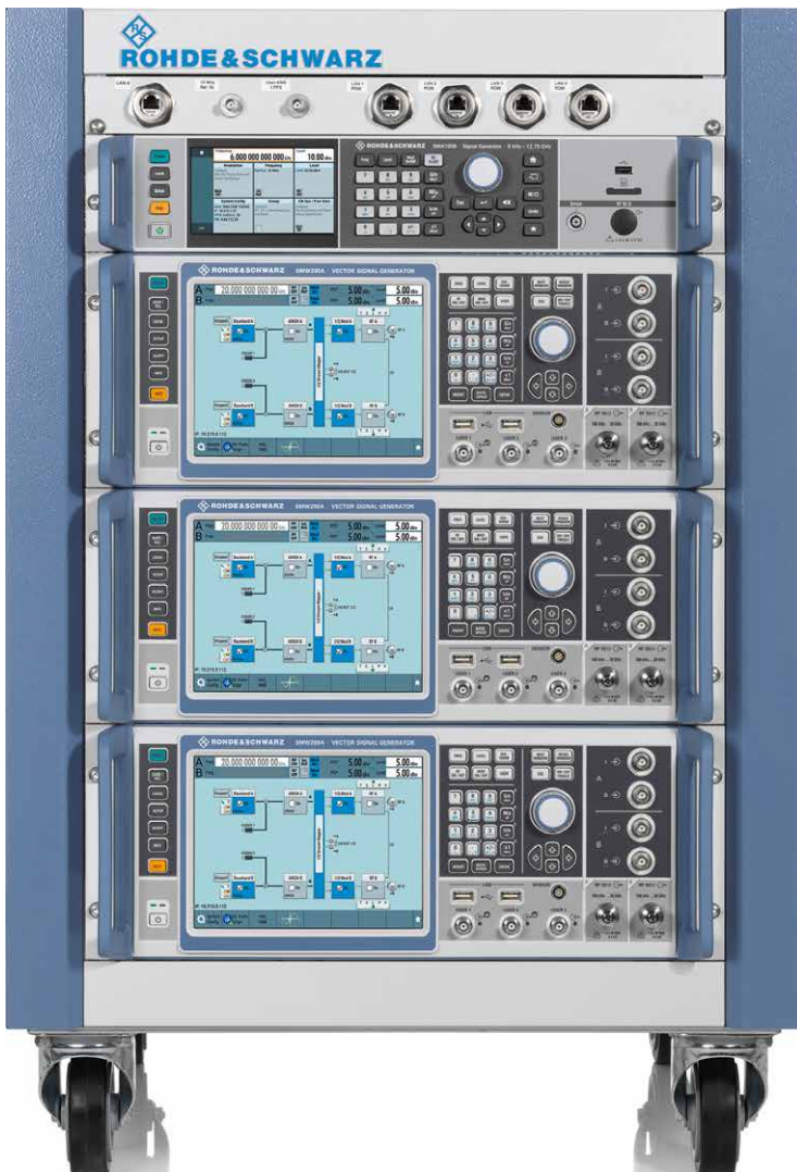
Bild 3: 6-kanaliges Radar- / GNSS-Testsystem aus drei Vektorsignalgeneratoren R&S®SMW200A und einem Analogsignalgenerator R&S®SMA100B für das LO-Signal.
