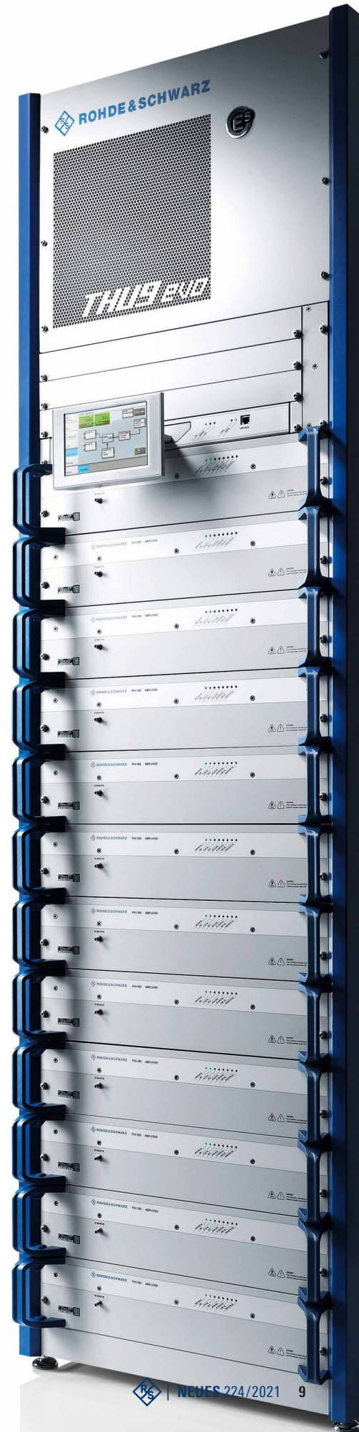
Das Broadcast Service and Control Center R&S®BSCC2.0 erweitert ein Mobilfunk-Kernnetz um die Fähigkeit, TV-Sender für die Übertragung von Broadcast/Multicast-Inhalten einzusetzen. Die aktuellen Rohde & Schwarz-Senderbaureihen wie R&S®THU9evo (rechts) sind dafür vorbereitet.
