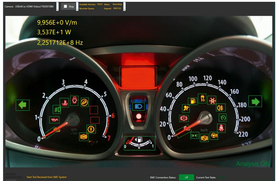
BILD 2: Messansicht mit überlagerten Informationen aus einem EMS-Test. Alle Anzeigeelemente sind als ROIs deklariert und werden auf Änderungen überwacht.
