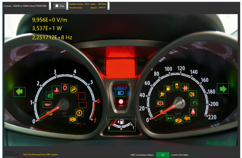
Fig. 2 : Affichage de la mesure avec la superposition d'informations issues d'un test EMS. Tous les éléments d'affichage sont déclarés comme ROI et sont surveillés pour détecter toute modification.
