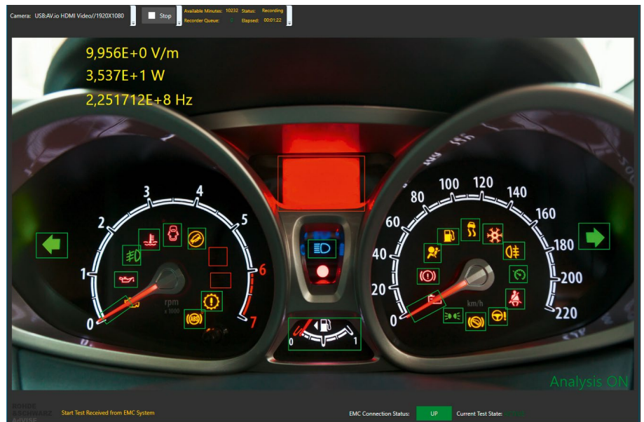
Fig. 2: Visualización de la medición con información superpuesta tomada durante un ensayo de EMS. Todos los elementos de indicación están declarados como regiones de interés (ROI) y se supervisa si ocurren alteraciones.
