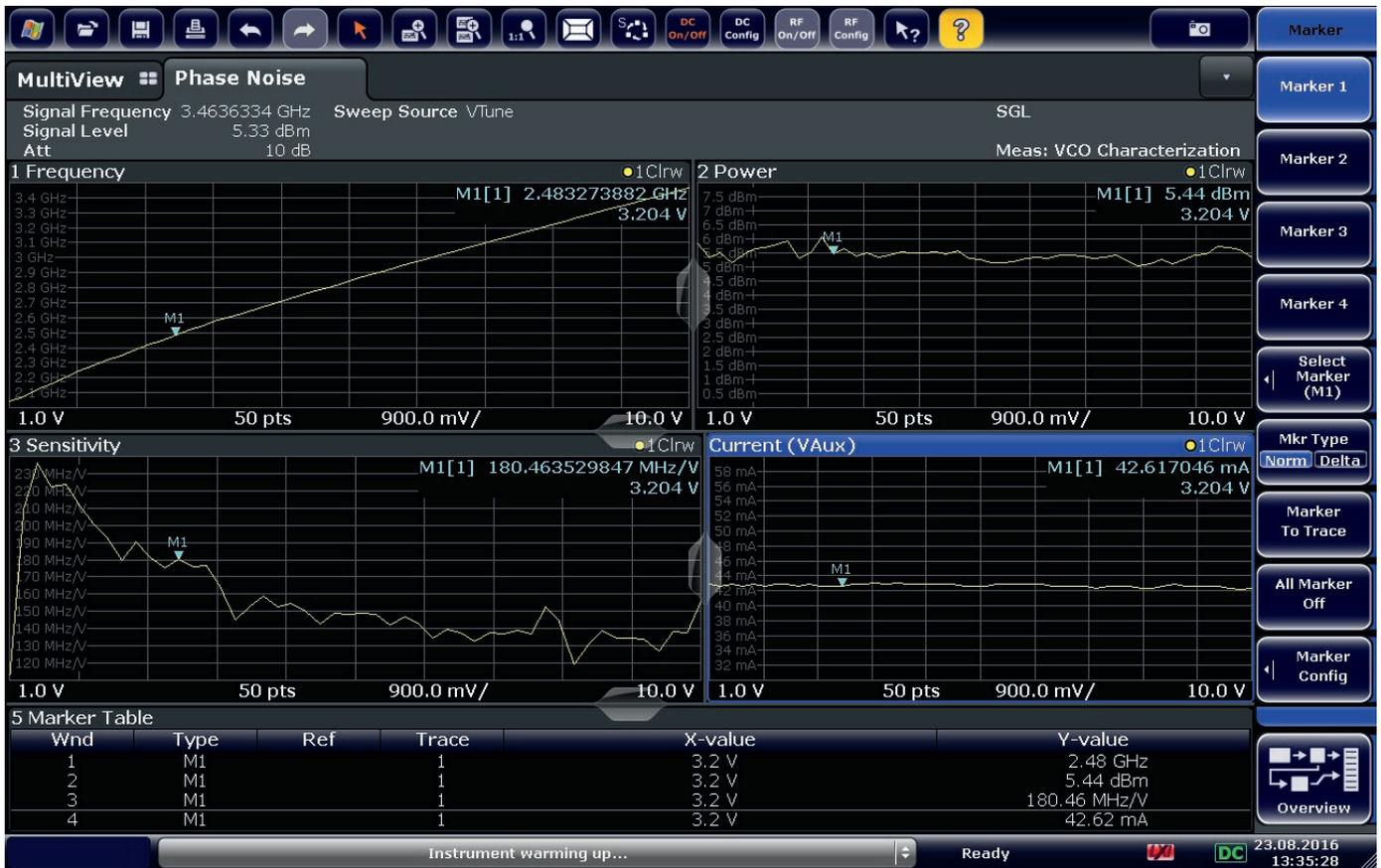
BILD 2: Eine typische VCO-Messung. Wichtige Parameter wie Frequenz, Leistung, Abstimmsteilheit und Stromverbrauch werden in Abhängigkeit von der Abstimmspannung gemessen.
