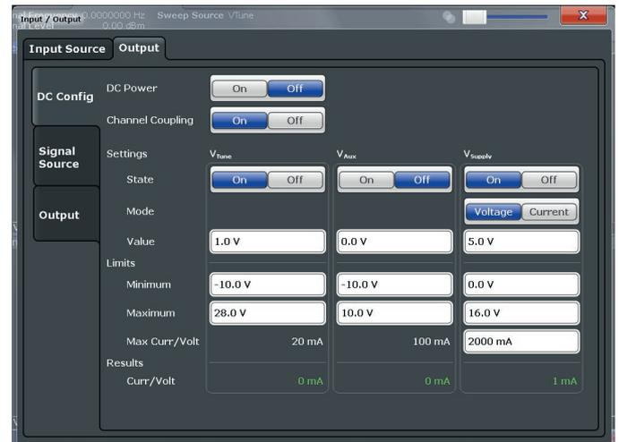
BILD 3: Einstellmenü für die internen Spannungsquellen des R&S®FSWP.
